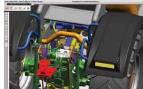
Narzędzia NX do walidacji złożenia zawierają możliwości planowania ścieżek przemieszczania części, które optymalizują projekty pod kątem łatwości montażu, demontażu i obsługi.
