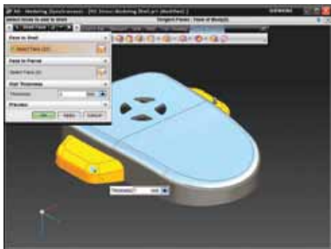
NX Synchronous Technology umożliwia konstruktorom dokonywanie edycji zaimportowanych modeli CAD.
